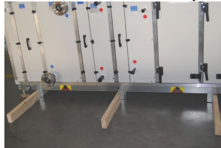
Gesetzte Holzbalken für den Transport
